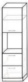
Модуль для бытовой техники с присадкой под 1 фасад и с 2 ящиками 1 или 2 полки ЛДСП
